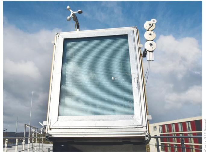
**Bild 6** Das Foto zeigt den Prüfstand am ZAE Bayern in Würzburg mit eingebauter Verglasung und Lichtlenkjalousie. Die Messungen erfolgten bei natürlicher Sonneneinstrahlung. Die Messbox mit der eingebauten Probe wurde der Sonnenbahn im Tagesverlauf dem veränderten Azimut im Horizontalkreis um eine vertikale Achse nachgeführt. Der gewünschte Sonnenhöhenwinkel wurde durch ein Verkippen der Apparatur um eine horizontale Achse realisiert.
